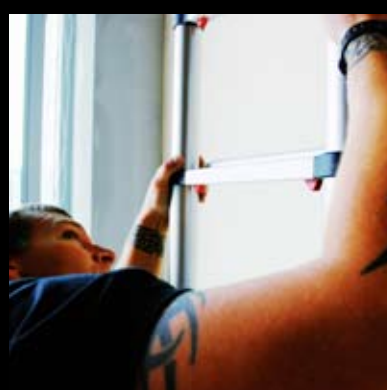
De röda levrarna under steget indikerar att stegen är låst.
