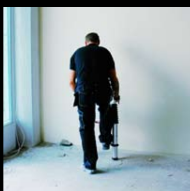
Börja att dra ut stegen uppifrån om den ska användas i sin fulla längd.
